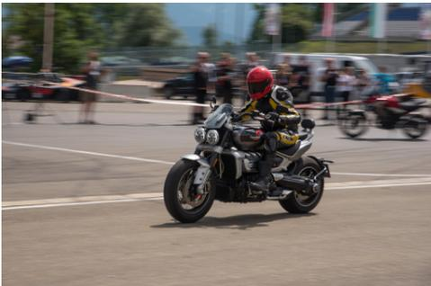
Die Fahrergeräuschemessung der Triumph Rocket III ergab bei Beschleunigung mit Schaltvorgang und Vollgas-Stellung 87,4dB.
