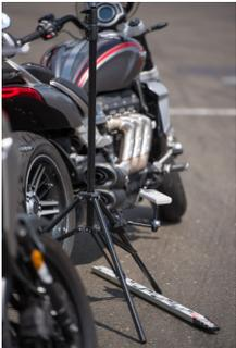
Die Standgeräuschemessung der Triumph Rocket III ergab 93,3dB.
